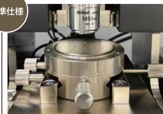
小型ホルダー ※試料サイズ φ50 x t3.5 mm
