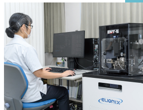
▲ 薄膜材料の分布を連続的に測れる試験機「ELIS-BODEN S」で作業する社員。
